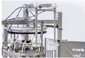
鳥の保持位置及びカット深さを稼働中でも容易に調整する為の2つのハンドル
